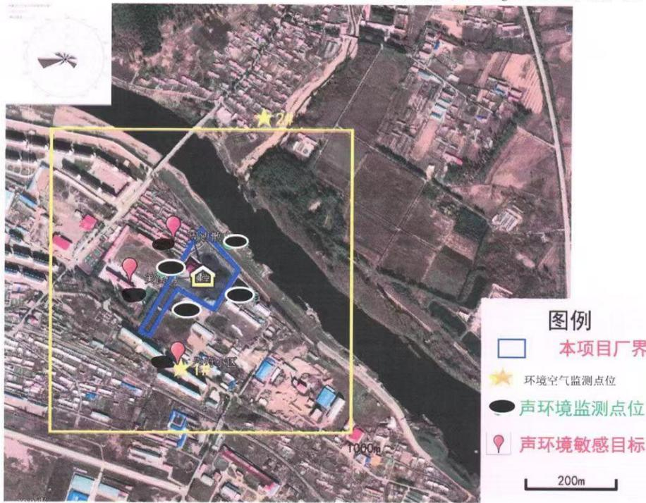
图1 环境空气、噪声敏感点、3#供热站噪声监测布点图
